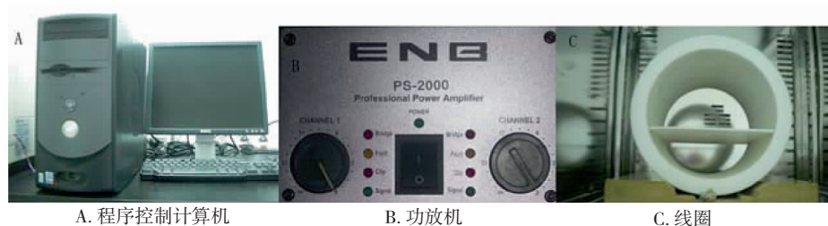
磁场线圈部分安装于 5% \text{CO}_2 、 37^{\circ}\text{C} 以及完全饱和湿度的培养箱中, 培养皿可放置于线圈中进行磁场处理
