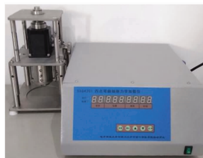
图 1 四点弯曲细胞力学加载仪 (四川大学与电子科技大学联合研制)
