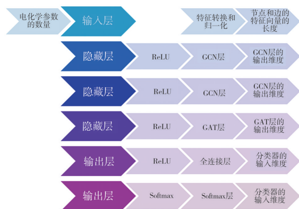
图1 TS融合图神经网络模型结构示意图
